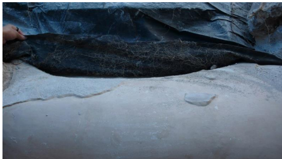
Figura IV-3: Detalle de la proliferación de micro raíces en el geotextil (Foto por Alice Desprat).
