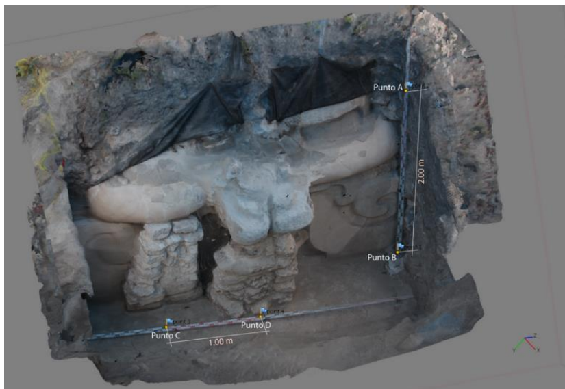
FIGURA XVIII-7: Modelo fotogramétrico 3D preliminar obtenido a partir de las tomas del Mascarón Norte elaboradas el 3 y 7 de mayo. Proceso de georeferenciado y escalamiento vertical (puntos A y B) y horizontal (puntos C y D) (Generación de modelo 3D, post procesamiento y tomas fotogramétricas por Carlos Pallán).
