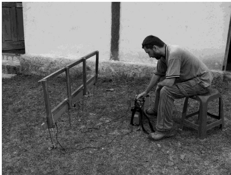
Figura XVII-2: RM Terrametro SAS 1000 (ABEM Instrument AB, Suecia).
